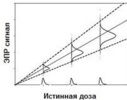
Рисунок 7 – Схема моделирования амплитуды и дозы для оценки суммарной неопределенности
